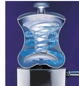
Abbildung 1: Strömungsführung des Wassers im Kolloidator im Längsschnitt
